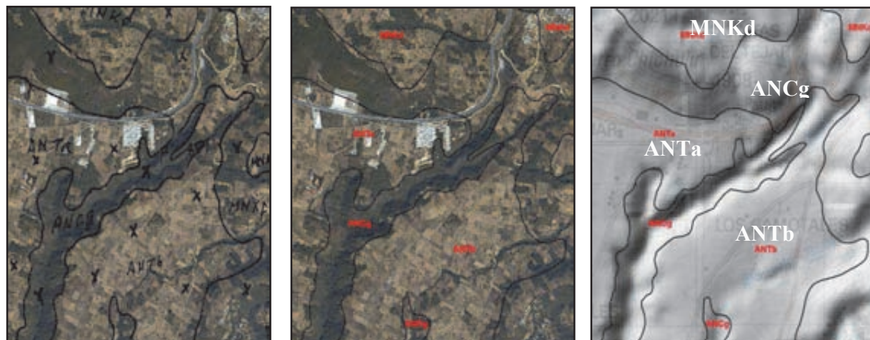
Figura A-7. Proceso de vectorización de los acetatos ortorectificados y asignación de atributos
