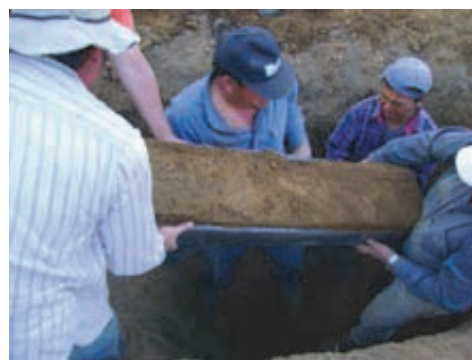
Figura A-25 Obtención de columnas de suelo para conformar monolitos (Foto: Archivo UPGGR – MAGA 2007)
