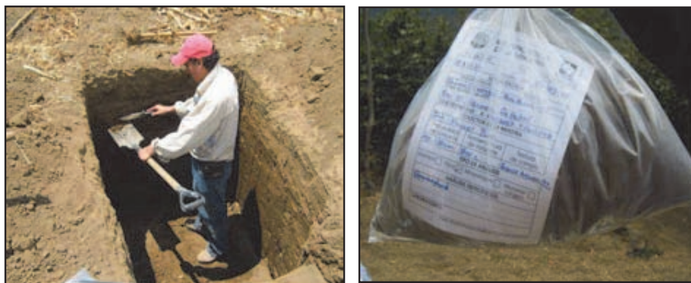
Figura A-22 Toma de muestras e identificación de las mismas para envío a los laboratorios de suelos (Foto W. González, 2009)
